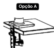
Instalação por morsa 0.8"-3.5" (20mm-90mm)
