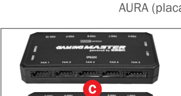
CAPACIDADE PARA 10 FANS
