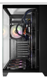
RADIADOR FIXADO EM GABINETE
