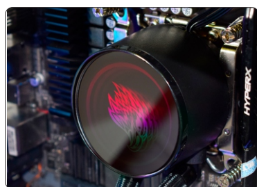
BOMBA FIXADA EM PLACA-MÃE
