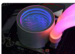
BOMBA FIXADA EM PLACA-MÃE
