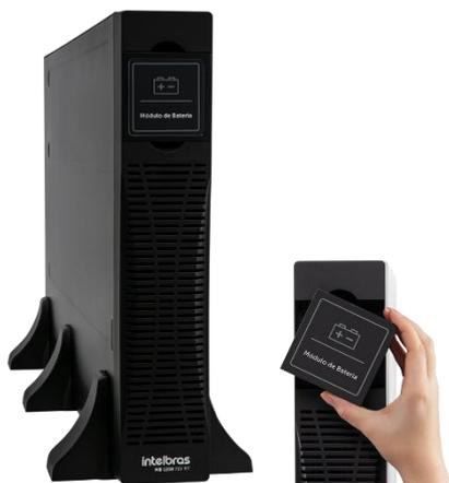
O MB 1209 72 V RT é um módulo de baterias formato rack/torre. Possui 12 baterias seladas de chumbo-ácido (VRLA) 12 V 9 Ah e é compatível com os nobreaks DNB 3.0 kVA RT, de topologia online de dupla conversão e formato de onda senoidal.
