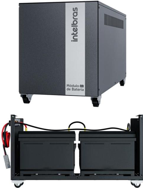
O MB 0245 24V possui 2 baterias estacionárias 12V 45Ah em série (24V) e é compatível com os nobreaks de barramento 24V que possuem conexão de engate rápido SB 50, que permite expansão de autonomia.
