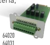
**Cartão de comunicação SNMP:** Permite realizar gerenciamento local ou remoto do UPS através dos protocolos SNMP/HTTP - TCP/IP.
