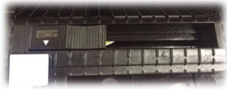
Com o sensor de etiquetas totalmente encostado no lado esquerdo (padrão de fábrica), a configuração no software L42Pro Full Utility deve ser:
