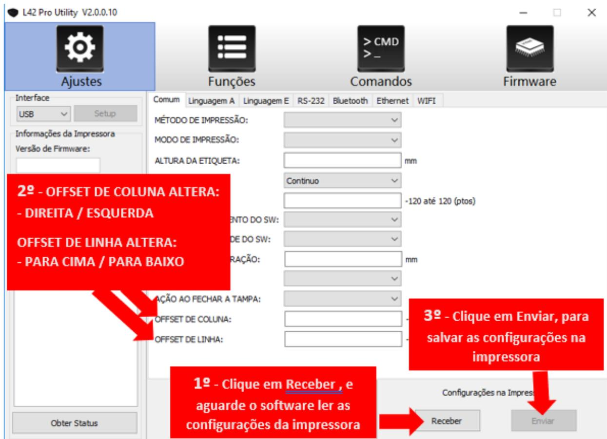
Insira os valores manualmente no campos de OFFSET DE COLUNA (desloca a impressão para Esquerda / Direita. Ou no campo OFFSET DE LINHA (desloca a impressão para Cima / para Baixo). Depois de enviar os novos valores para a impressora, faça um teste de impressão para verificar se a posição de impressão está correta.
