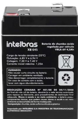
A XB 645 é uma bateria de chumbo-ácido regulada por válvula selada VRLA recarregável, livre de manutenção e protegida contra vazamento. Uma bateria para uso geral e com uma vida útil de até 8 anos em regime de flutuação, ideal para aplicação em iluminação de emergência e centrais de alarme.
