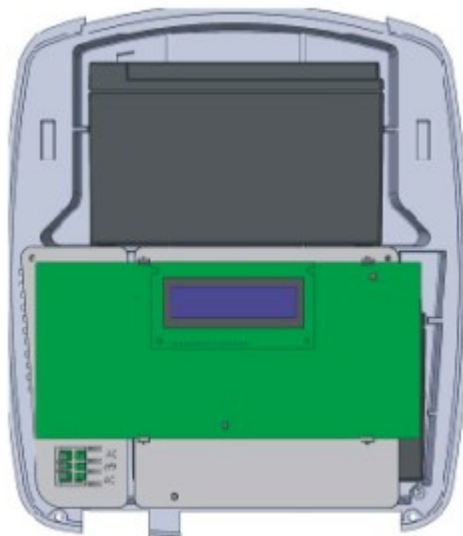
Figura 3: Fixação da placa de controle
