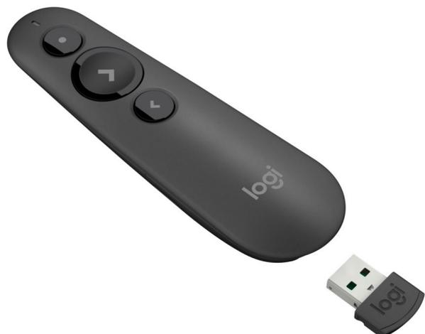
\*\* Quando a pilha está fraca, o R500s entra no modo de economia de energia, desativando o laser para aumentar a duração da pilha para que você possa continuar as apresentações uma semana mais. A autonomia das pilhas varia, dependendo do uso e das condições de computação.
