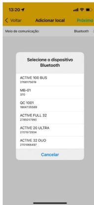
5. Termine o cadastro do local com nome e a senha para conectar na central. Clique em conectar. O programador vai conectar na central de alarme e baixar a programação. Durante a conexão Bluetooth o LED Boot fica aceso 🔵.
