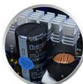
CAPACITOR ELETROLÍTICO (FILTRO DE ENTRADA)
