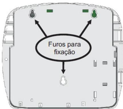
O desenho ao lado, indica furos de fixação. Os mesmos devem ser utilizados para a instalação do eletrificador.
