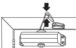
2 - O braço da mola (com suporte) deve ser montado a 90°. Para desmontá-lo do antebraço, pressione entre as duas partes com uma chave de fenda.
